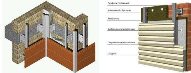
*Вне зависимости от выбранного варианта подконструкции первая и последняя направляющие профилей должны быть закреплены на углах здания и исключать провис фасадной панели на подконструкции по торцам более чем на 10 мм с каждой стороны.*
